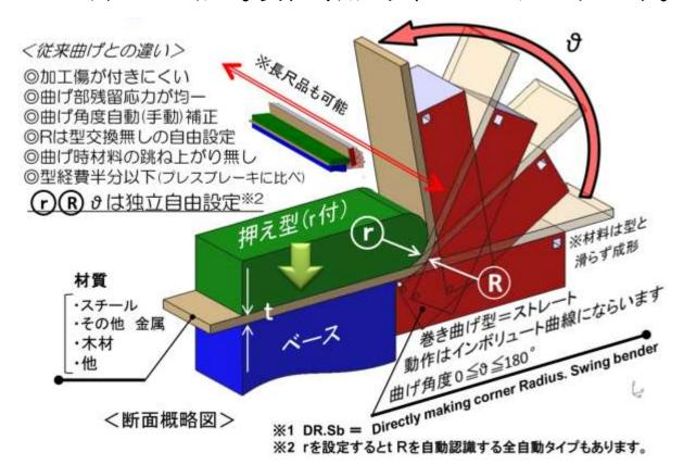
スウィングベンダーは、ベース、押え型(r付)、巻き曲げ型(ストレート)で構成される新・板曲げ機です。材料を無理無く曲げられ、従来では傷が付いたり、曲げられなかった材料も美しく曲げることができます。
